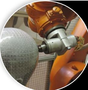
PRONTA ALL'USO, i tagli a croce sono realizzati con estrema precisione da robot computerizzati.
